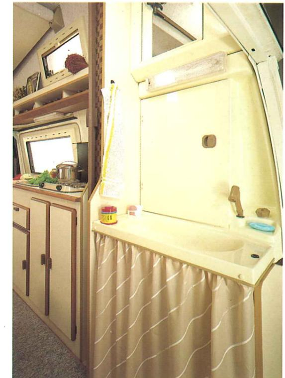
**Durch eine Fallwand läßt sich der Waschraum zum Wohnraum hin abteilen. Der ausziehbare Kombi-Wasserhahn am Waschbecken kann an heißen Tagen auch als Außendusche verwendet werden.**
